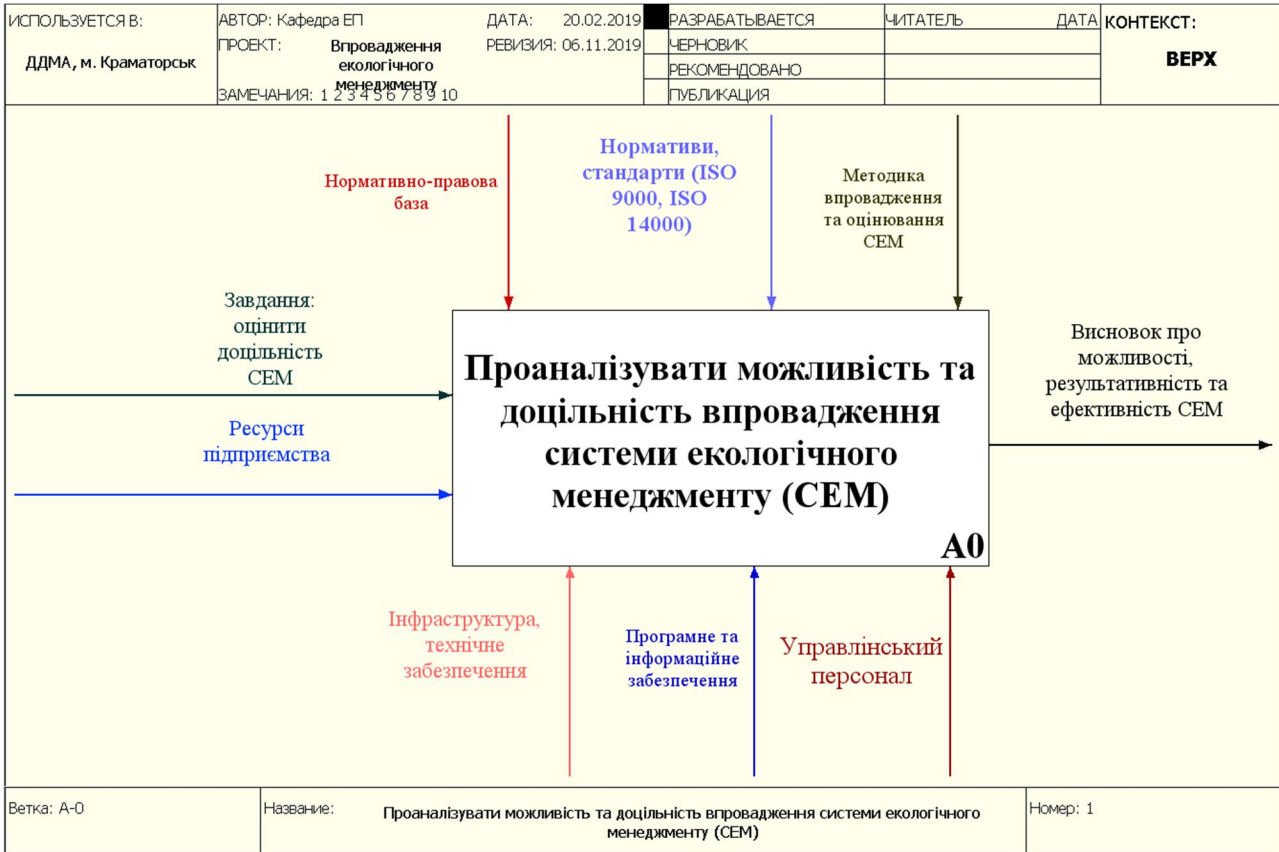
Рис. 1. Контекстна діаграма (вищого рівня A-0) функціонального моделювання нотації IDEF0 SADT - моделі (авторська розробка)
